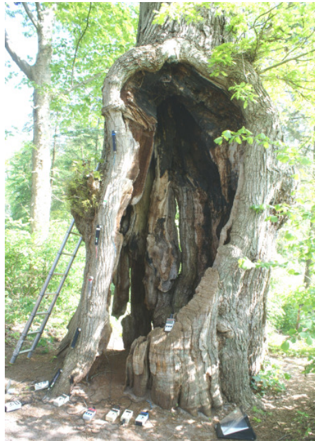
Abb. 1: Die Botesheimer Eiche, Stammdurchmesser 225 cm, Resttragfähigkeit 3 %, abgebaut 97 %. darüber kein Torso, sondern eine unbeschnittene Krone von 25 m Höhe. Ein über die Jahrhunderte stabiles Biotop. Hier mittels 8 Elastometern und Inclinometer in 4 Richtungen statisch offengelegt.
