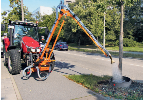
Gießfahrzeug mit Gießarm bewässert den Gießrand arboGreenWell.
